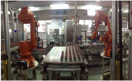
汽车用电机上下料装配台
